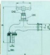
Il rubinetto erogazione a collo con portagomma viene utilizzato per l'erogazione di un liquido ed il sistema di chiusura offre la possibilità di regolare la portata. Detto rubinetto può anche essere azionato a chiave asportabile, garantendone la sicurezza.
